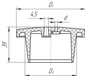
d - диаметр отверстия под крепление тросика
