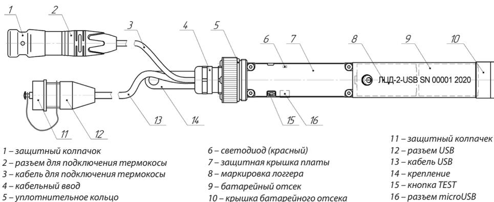
**Рис.2.** Устройство ЛЦД-2-USB
