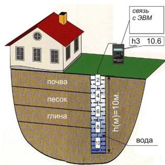
Возможно объединить радио канальные стационарный и автономный варианты в единую систему с автоматизированным сбором данных и хранением на централизованном сервере. Доступ к данным осуществляется с любого автоматизированного рабочего места (АРМа) по зашифрованному каналу, включенного в одну сеть с сервером через ПО «ГеоМет».
