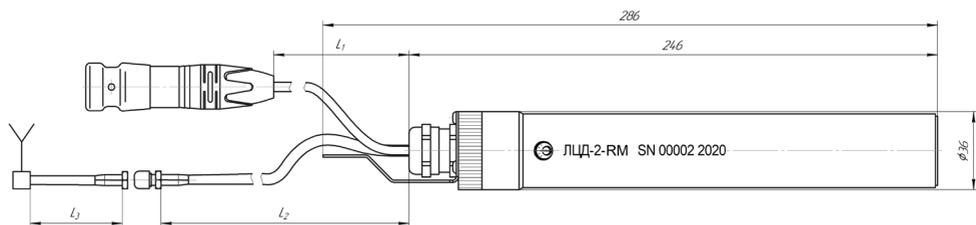
$L_1$  - длина кабеля от логгера до разъёма термокосы, м (от 0,5 до 10,0 м, шаг 0,5 м);
