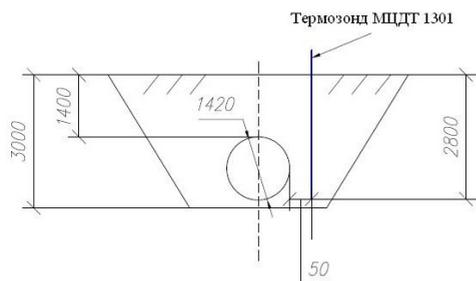
**Рис. 3** Схема размещения МЦДТ 1301 возле подземного газопровода
