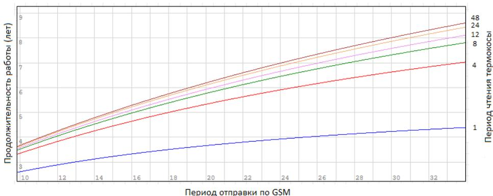
**Рис.3.** Расчетное время работы логгера цифровых датчиков ЛЦД-2-GSM
