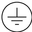
Клемма защитного проводника;
