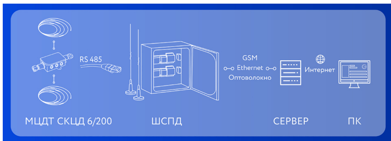
Рисунок 10. Автоматизированный мониторинг температуры при помощи стационарного контроллера СКЦД.
