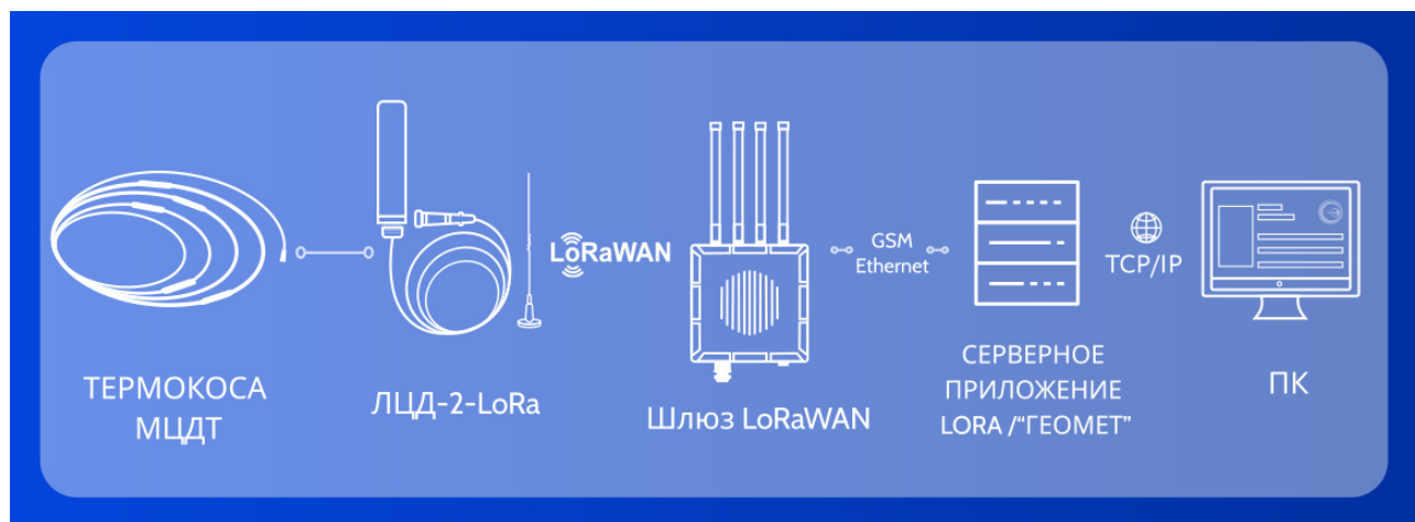
Рисунок 8. Автоматизированный мониторинг температуры при помощи логгера ЛЦД-2-LoRa.
