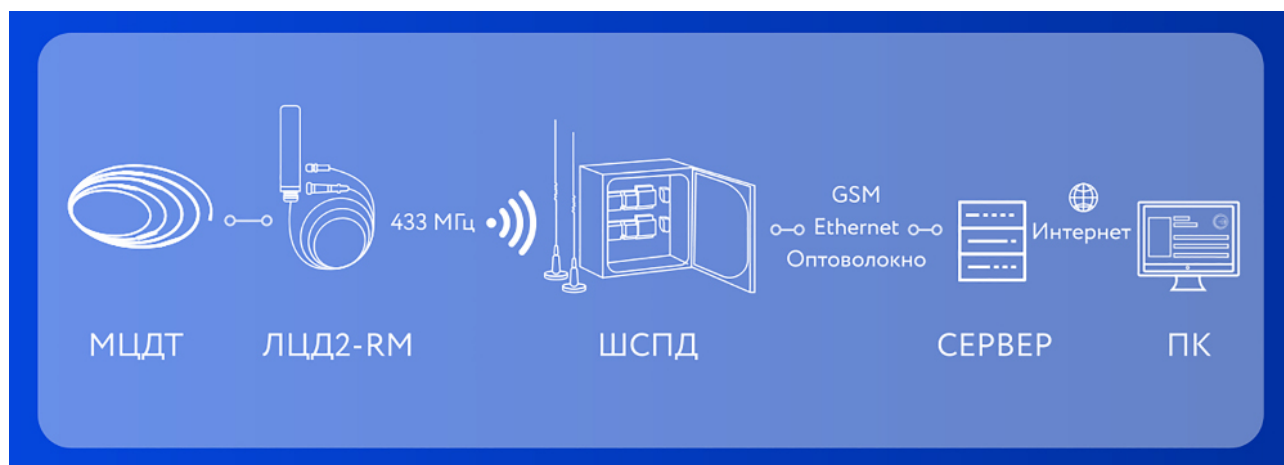
Рисунок 11. Автоматизированный мониторинг температуры при помощи логгера ЛЦД2-РМ
