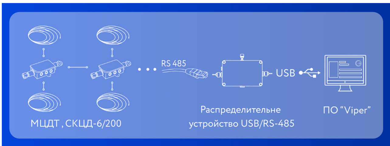
Рисунок 9. Стационарный вариант мониторинга температуры с проводной передачей данных при помощи контроллеров СКЦД-6/200.
