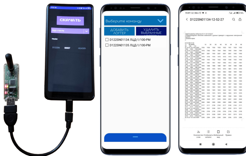
Рисунок 6. ПО для чтения данных с радиологгеров при помощи смартфона с операционной системой Android
