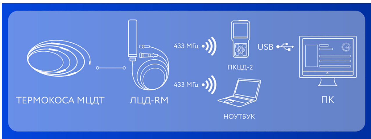
Рисунок 5. Мониторинг температуры в ручном режиме при помощи логгера с радиоканалом ЛЦД-2-RM
