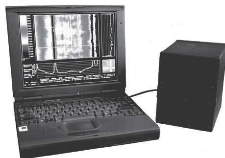
Рис.28.6 Система тепловизионного контроля
