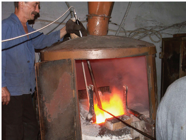
Рисунок 22.2 – Измерение температуры хлорида бария ИК-термопарой в солевой печи.
