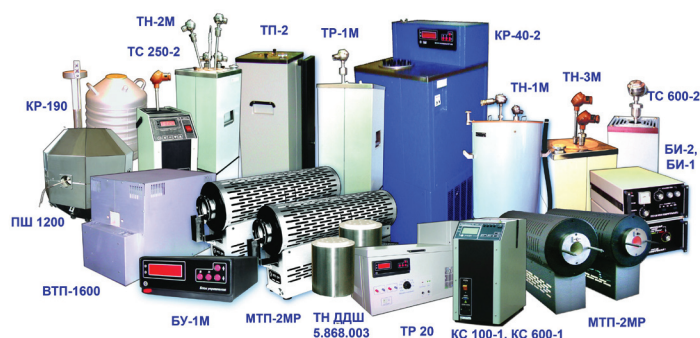
Рис. 28.2 Средства передачи, измерения и воспроизведения температуры для контактной термометрии.
