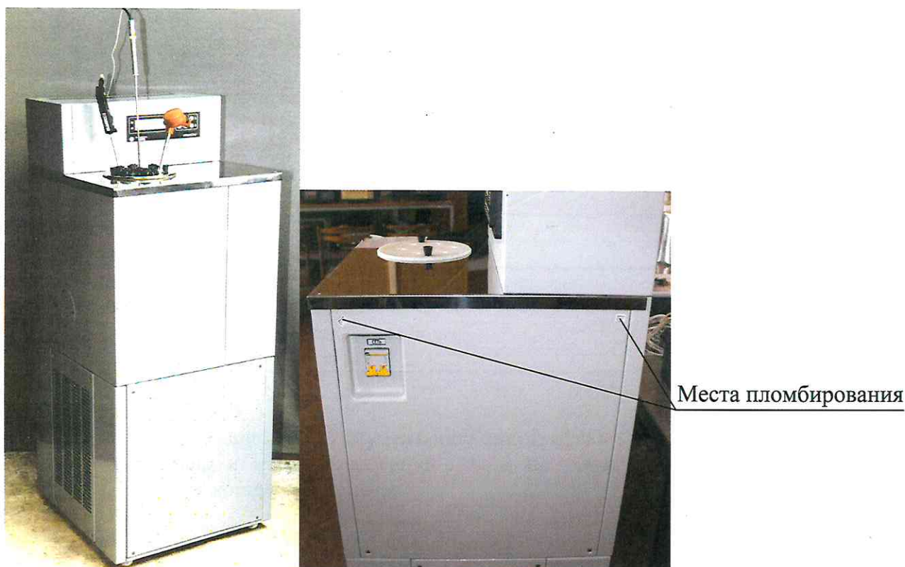
Рисунок 1 – Общий вид и схема пломбировки от несанкционированного доступа криостатов
