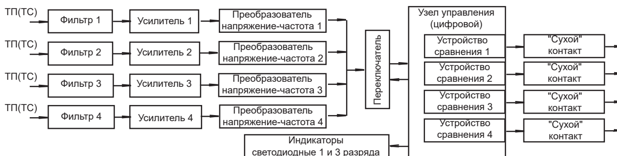
Структура регулятора температуры РТМ-4К
