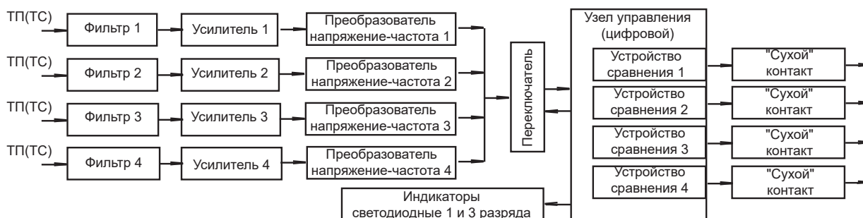
Структура регулятора температуры РТМ-4К
