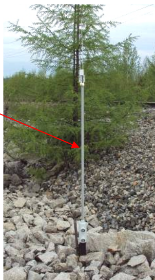
Автомобильная антенна для сбора информации со скважин
