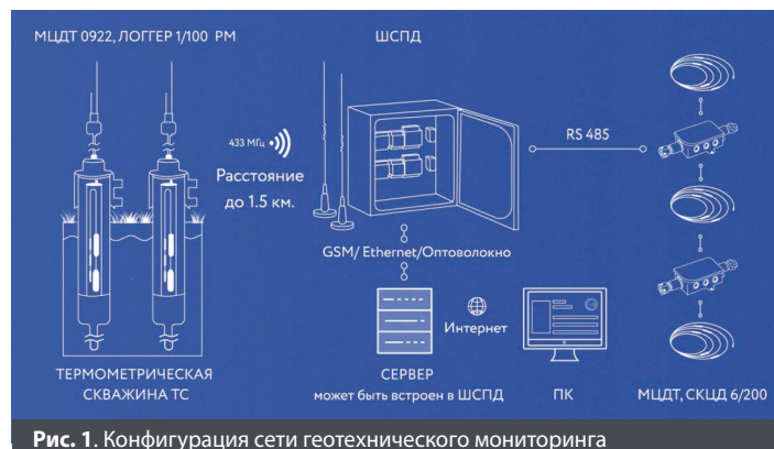
Рис. 1. Конфигурация сети геотехнического мониторинга
