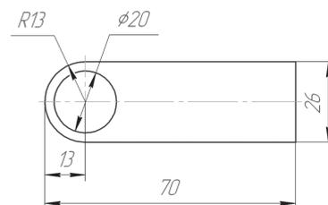
Габаритный чертеж приемника ИК
