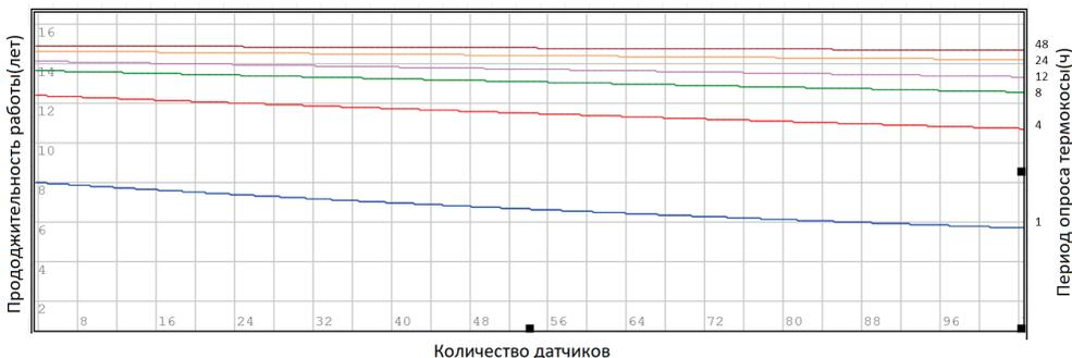
**Рис.3.** Расчетное время работы логгера цифровых датчиков ЛЦД-2-USB
