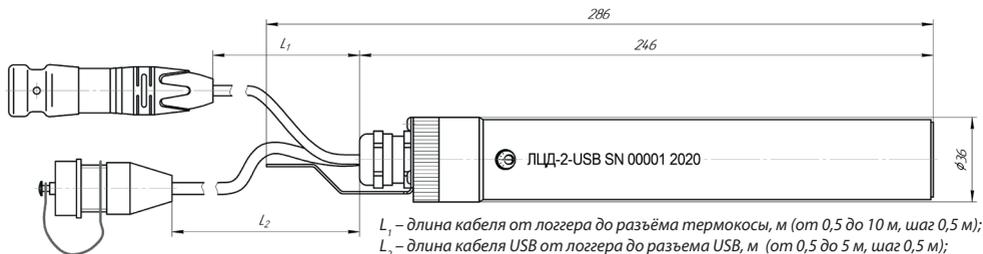
**Рис. 1.** Габаритный чертеж логгера цифровых датчиков ЛЦД-2-USB
