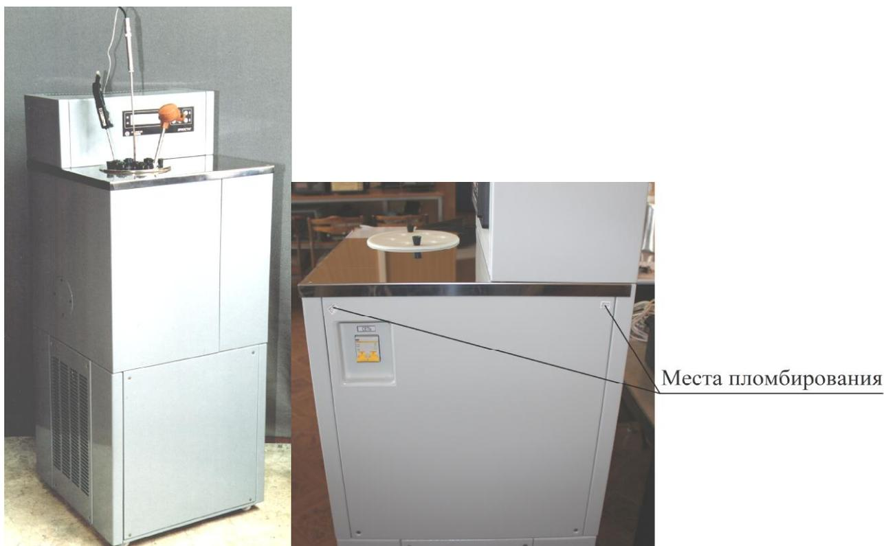
Рисунок 1 – Общий вид и схема пломбировки от несанкционированного доступа криостатов
