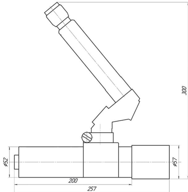
Габаритный чертеж пирометров прецизионных ПД-4-01...ПД-4-05
