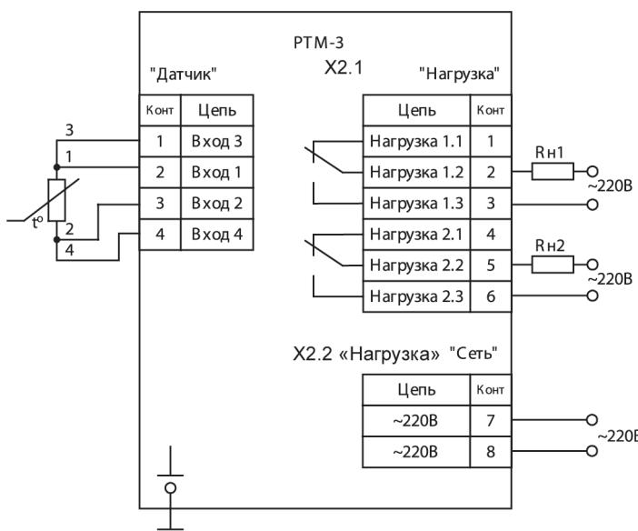
**Схема подключения РТМ-3, предназначенных для работы с термопарными датчиками**
