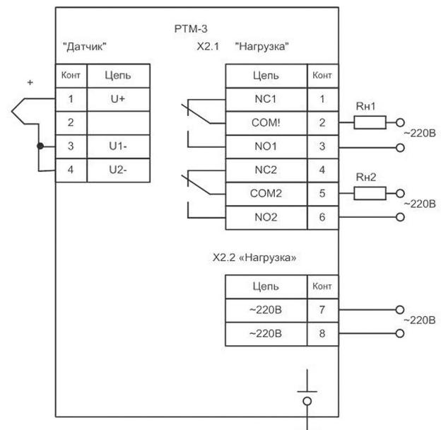
**Схема подключения РТМ-3 при использовании ПИ с выходным током**
