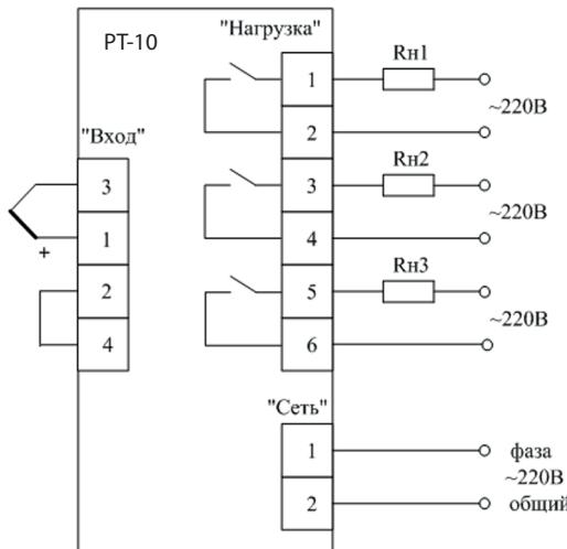
Схема подключения РТ-10, предназначенных для работы с термометрами сопротивления
