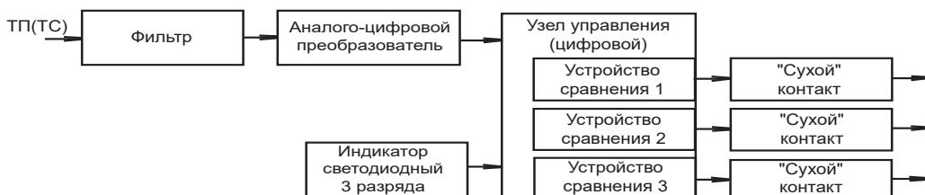
Схема подключения РТ-10, предназначенных для работы с термопарными датчиками (кроме ТПР(B))
