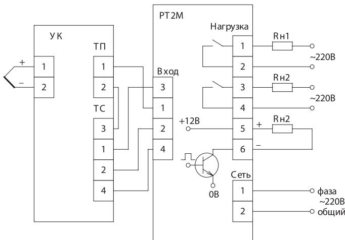
**Схема подключения PT2M, предназначенных для работы с датчиками ТПР(В)**
