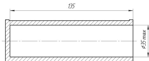
Рис.3 Блок выравнивающий ДДШ7.069.003-02. (Остальное - см. рис.1)
