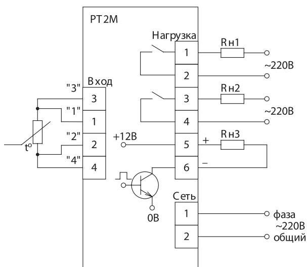
**Схема подключения PT2M, предназначенных для работы с датчиками, имеющими унифицированный токовый выходной сигнал**
