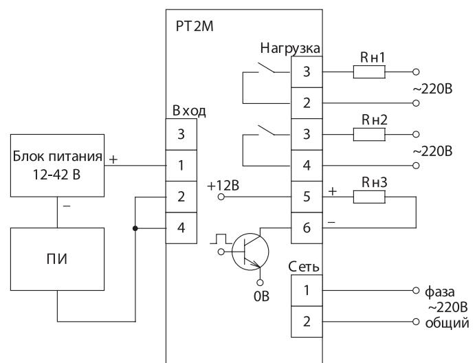
**Схема подключения PT2M, предназначенных для работы с датчиками, имеющими унифицированный выходной сигнал в виде напряжения**
