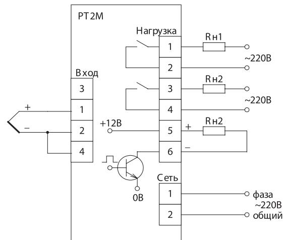
**Схема подключения PT2M, предназначенных для работы с термометрами сопротивления**
