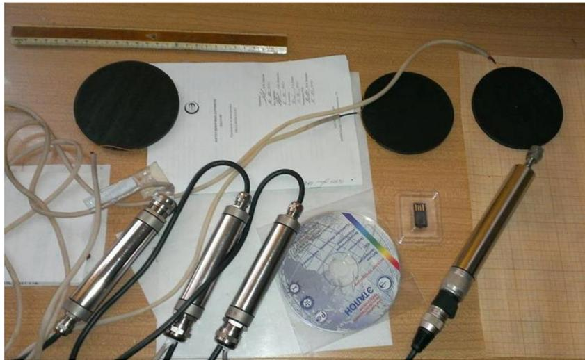
Рис. 2 - Измерительная система: ДТП-0924 и ЛЦД-1/100
