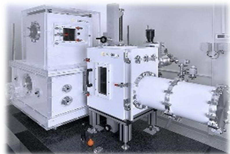
Вакуумный компаратор массы, применяемый для передачи единицы рабочим эталонам
