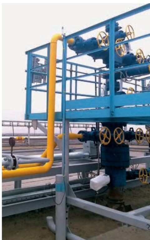
Термометрическое оборудование на газовой скважине
