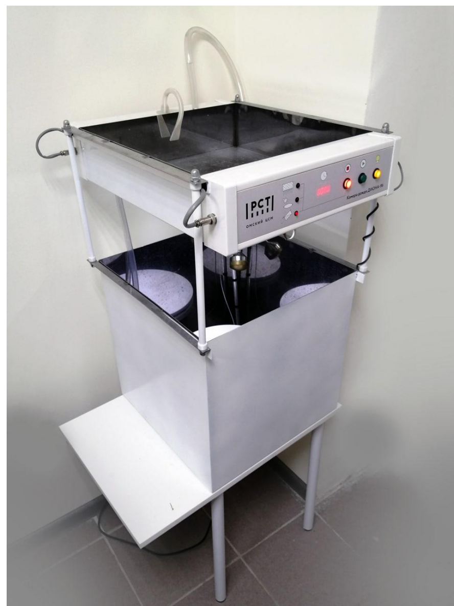
Производство испытательного оборудования для испытаний продукции по классу IP – камера дождя ДИОНА-96
