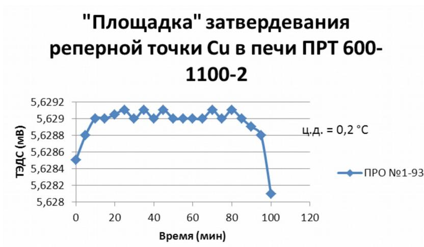
Рисунок 19 - площадка затвердевания реперной точки меди в печи ПРТ 600-1100-2
