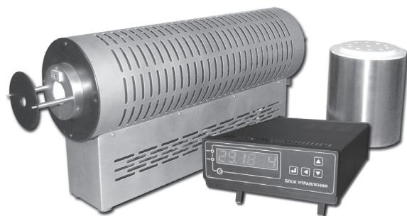
печь трубчатая ПТ с установленной диафрагмой БУ-7-4 термостат нулевой ДДШ 5.868.003
