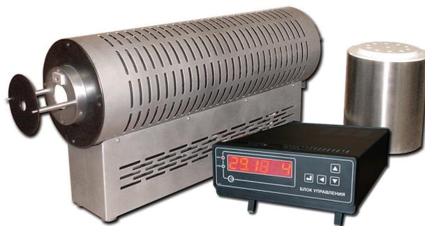
печь трубчатая ПТ с установленной диафрагмой
