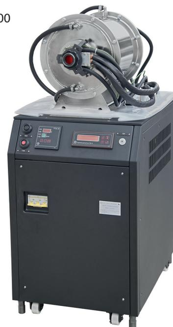
Температурой излучателя управляет оптоволоконный быстродействующий пирометр, расположенный на лицевой панели шкафа управления (ШУ) и обеспечивающий необходимую точность поддержания температуры полости излучения. Управление температурными режимами излучателя осуществляется как с клавиатуры пирометра так и с ЭВМ, посредством интерфейсного соединения.
