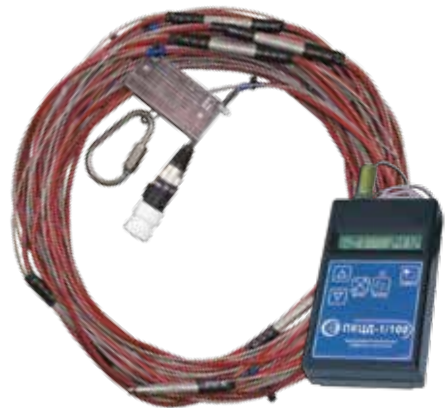
Рисунок 1 – Термокоса (МЦДТ 0922) с контроллером (ПКЦД-1/100)
