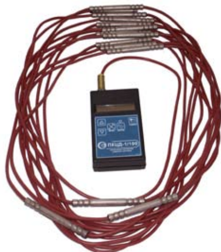
Рис. 1 – Термокоса (МЦДТ 0922) с контроллером (ПКЦД-1/100)
