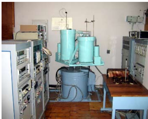
Рисунок 1 - государственный специальный эталон единицы удельной теплоемкости твердых тел в диапазоне температур от 1337 до 1800 К “ГЭТ 67-75”
