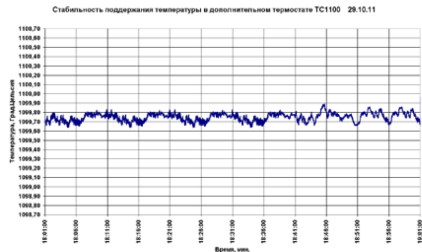
Рисунок 5 - стабильность температуры в дополнительном термостате
