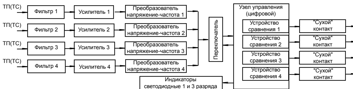
Структура регулятора температуры РТМ-4К
